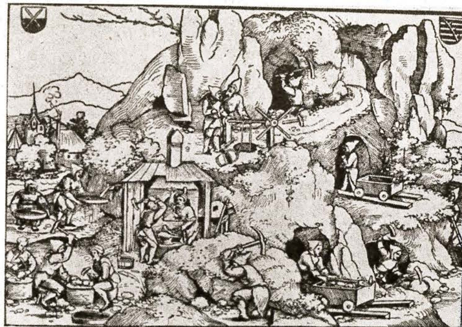
Rudnik v srednjem veku. Na desni rudarji kopljejo rudo, na levi jo v rešetih spirajo. V peči na sredi rudo žgejo, levo spodaj pa že obdelujejo kovino.
